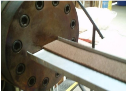
Extrusora doble tornillo MILACRON TC-35 T °C= 170-180 / rpm= 4
